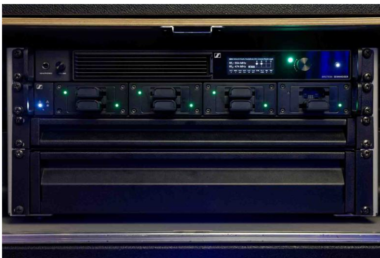
Die Spectera Bse Station, eine Ladestation L 6000 und zwei Schubladen für die SEKs und Zubehör – das Breitbandsystem Spectera braucht nur wenig Platz
